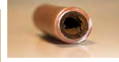
Conduite de chauffage au sol fragilisée et encrassée.
